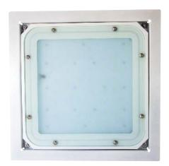
Installation : Recessed Warranty : 5 Years Lamp Type : LED Housing : Aluminium Glass : Tempered Glass ΙP : 65 Kelvin : 3000 - 4000 - 6000 CRI : >80 Led Lifetime : 50.000 h Power Supply: 110-240V 50-60Hz Op. Temp. : -20°C / +45°C
